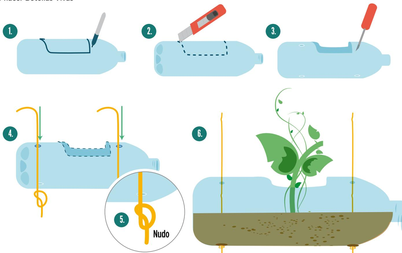
Figura 14. Un ejemplo de cómo ensamblar las botellas
